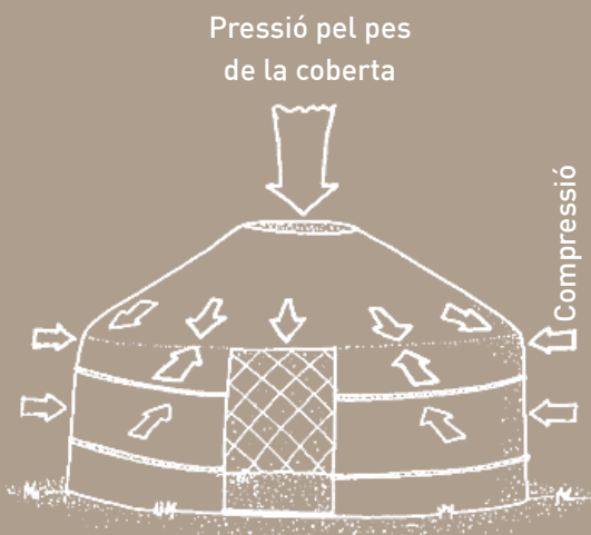
Fig. 57 - Funcionament de les forces en l'estructura.
