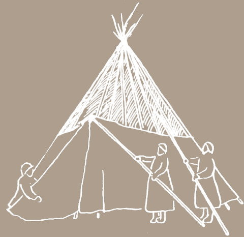
Fig. 82 - Posició revestiment: Els Nenets situen el revestiment de pells de ren sobre l'estructura amb uns pals llargs de fusta que els permeten fixar les pells a l'extrem superior.
